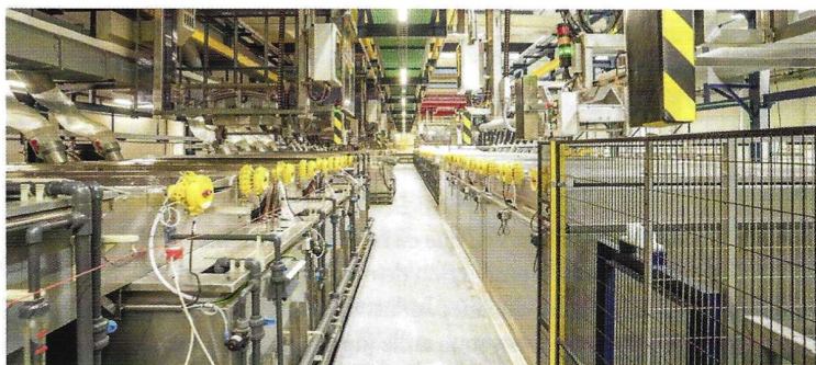
La nouvelle ligne automatique d'anodisation - traitement en surface de pièces d'aluminium comme des capots, des ornements - sera totalement opérationnelle à compter de l'été 2025. Les 80 cuves de 3 000 litres permettront de doubler les capacités d'anodisation.
